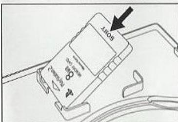
1. メモリーカードの△印の彫り込みのある面を上にして、端子側を左端のフックに斜めに差し込んでください。
